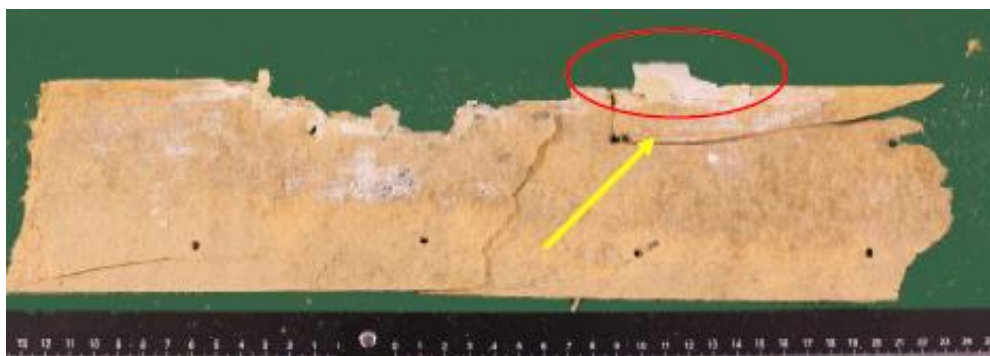
Bild 13. Golv-masonitbitens översida säkrad på västra väggen. Pil markerar den mindre masonitbit som skars ut inledningsvis. Ring markerar spackelrest som visar att det spacklats över golv-masoniten. Spackelrester syns också på masoniten hitom tomrummet efter bortbrutna bitar i masoniten.
