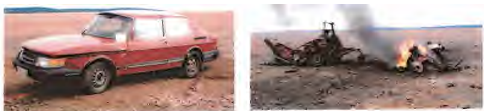
Figur 5. Foton på fordon före och efter innesluten detonation av under 5 kg sprängämne. Från verksamhet genomförd av FOI.
